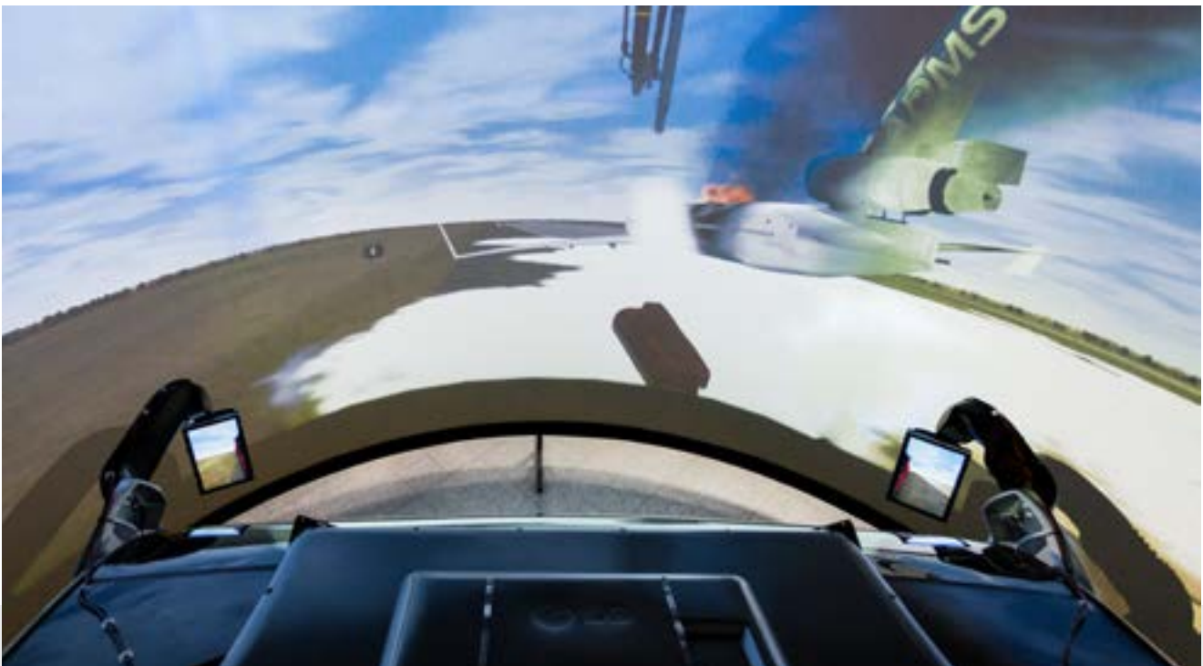
210°-Projektion mit Löscharm und Monitor im Sichtfeld, um den virtuellen Einsatz wie echt zu erleben.
