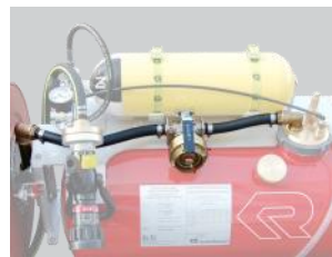
Tankschnellbefüllung und Fremdeinspeisung
