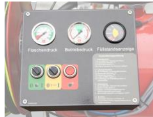
Armaturenkasten mit elektrischer Füllstandsanzeige
