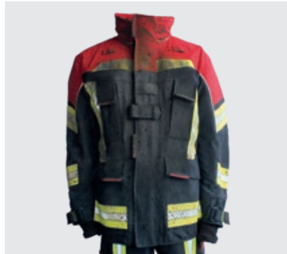
Schutzanzug FIRE FLEX/Störlichtbogenprüfung Keine strukturellen Schäden, Körper inkl. Halsbereich gut geschützt.
