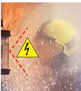
HEROS Helme/Störlichtbogenprüfung Keine strukturellen Schäden, Kopf- und Gesichtsbereich gut geschützt.
