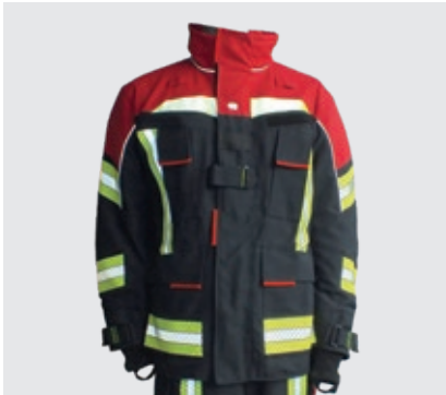
Schutzanzug FIRE FLEX/Störlichtbogenprüfung Keine strukturellen Schäden, Körper inkl. Halsbereich gut geschützt.
