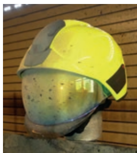
HEROS Helme/Störlichtbogenprüfung Keine strukturellen Schäden, Kopf- und Gesichtsbereich gut geschützt.
