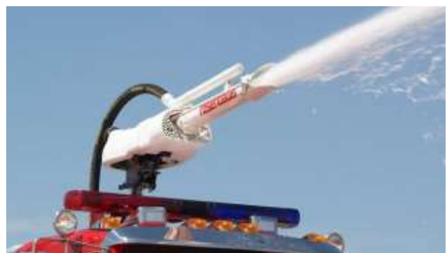
Werfer mit Schaumrohr und Deflektor, aufgesetztes Pulverrohr
