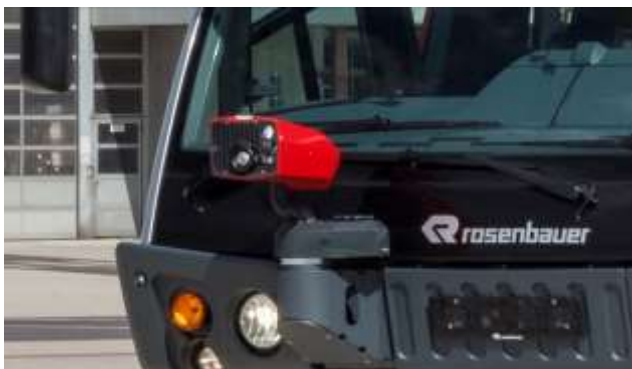
Werfer mit Hohlstrahldüse am Panther
