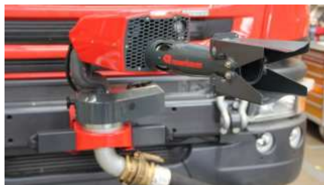
Werfer mit Hohlstrahldüse, Schaumrohr und Deflektor
