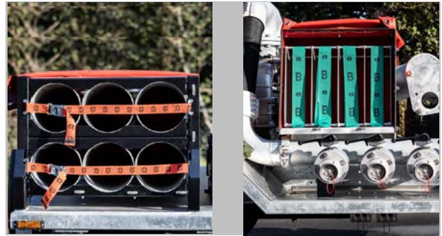
Halterungen: Saugschläuche in Kunststoffröhren vor dem Motor. und Druckschläuche in der Nähe der Druckabgänge.
