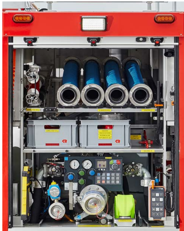
Platzsparender Einbau als Heckpumpenanlage z.B. im CL Aufbau
